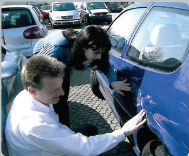
Moderne Karosseriestrukturen und höherfest legierte Bleche werden für konventionelle Ausbeultechniken immer mehr zum Problem. Deshalb setzen wir das revolutionäre MIRACLE-Ausbeulsystem ein. Bei den meisten Schäden an der Karosserie-Außenhaut ist damit eine sanfte und besonders schonende Reparatur Ihres Fahrzeugs möglich.
